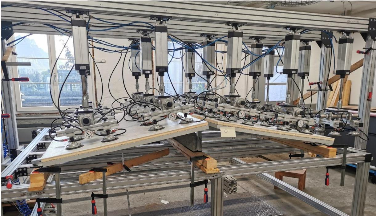
Abbildung 1 Prüf-Aufbau Schneelasttest der SmartSolarBox Version 5.0
